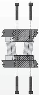
Die Größen 50 – 80 besitzen auf der Roboterseite Montagebohrungen mit Gewinde
