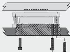
Alle Größen besitzen auf der Werkzeugseite Gewindelöcher. Die Größen 125 – 300 besitzen Führungsbohrung und Passstift-Bohrung zur Positionierung
