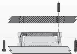
Die Größen 125 – 300 besitzen auf der Roboterseite Schulterbohrungen für Montage mit einer Passstift-Bohrung und einer angeordneten Schulter zur Positionierung
