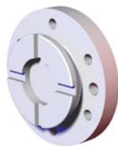
25 mm Anschlußadapter 6x Durchgangsbohrung Ø9 auf Ø70 Teilkreis 25 mm Höhe
