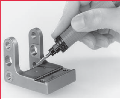
Modell 12R0400-43 beim Entgraten von Teilen aus hochfestem Stahl
