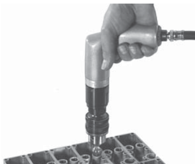
Modell 14CSL97-51 beim Senken und Entgraten eines Gußwerkstückes
