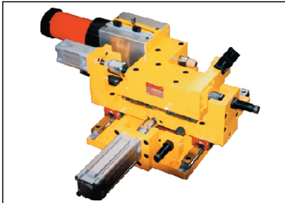
Sonderstanzeinheit für Doppellochungen \varnothing 12 in 1,2 mm dicke Stahlbleche
